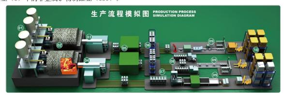
公司主要从事玻璃纤维及制品的生产、销售。玻璃纤维是一种新型无机非金属材料,以叶腊石、高岭土、石灰石、石英砂等矿石为原料(上图 01 各种矿石按照比例配制)经高温熔制(上图 02)、拉丝(上图 03 和 04)、烘干(上图 05 和 06)、络纱(上图 07)等工艺制造而成,其单丝直径为几微米到二十几微米,相当于一根头发丝的 1/20 至 1/5,每束纤维原丝都由数百根甚至上千根单丝组成。根据玻璃中的碱含量的多少,可分为无碱玻璃纤维、中碱玻璃纤维和高碱玻璃纤维,其中无碱玻璃纤维占据全行业 95%以上的产量规模。
